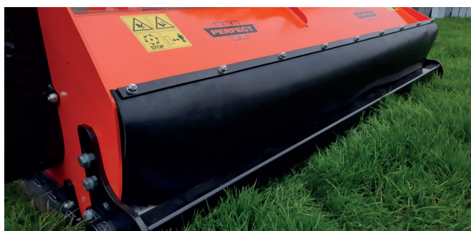
Protection d'éjection en caoutchouc
