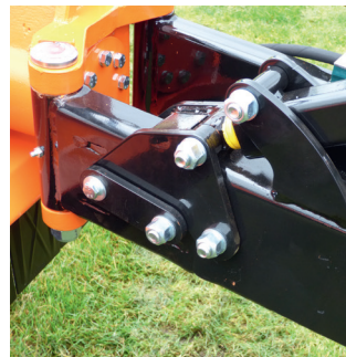
Dispositif anti collision dans les bras de dépo
